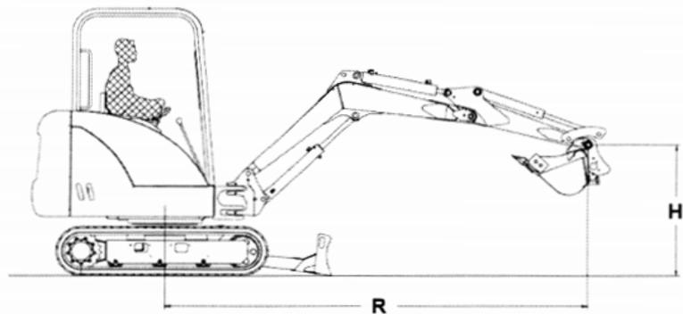
Hinweis: Hubpunkt ist der Löffelbolzen bei angebautem Standardlöffel und voll ausgefahrenem Löffelzylinder.
